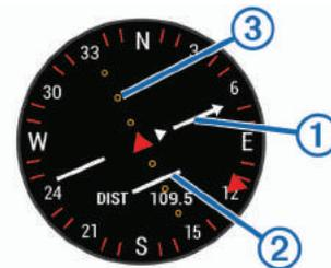
L'indicatore di percorso ① indica la posizione in relazione a una linea di percorso che conduce alla destinazione. L'indicatore di deviazione (CDI) ② fornisce l'indicazione di deviazione (destra o sinistra) dal percorso. I puntini ③ indicano la distanza fuori rotta.
